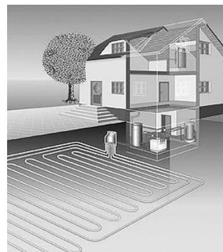
**Wärmepumpe mit Erdreichkollektor:**
