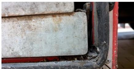
„Rostige Teile an Fahrgestell und Aufbau des LFB-A“
